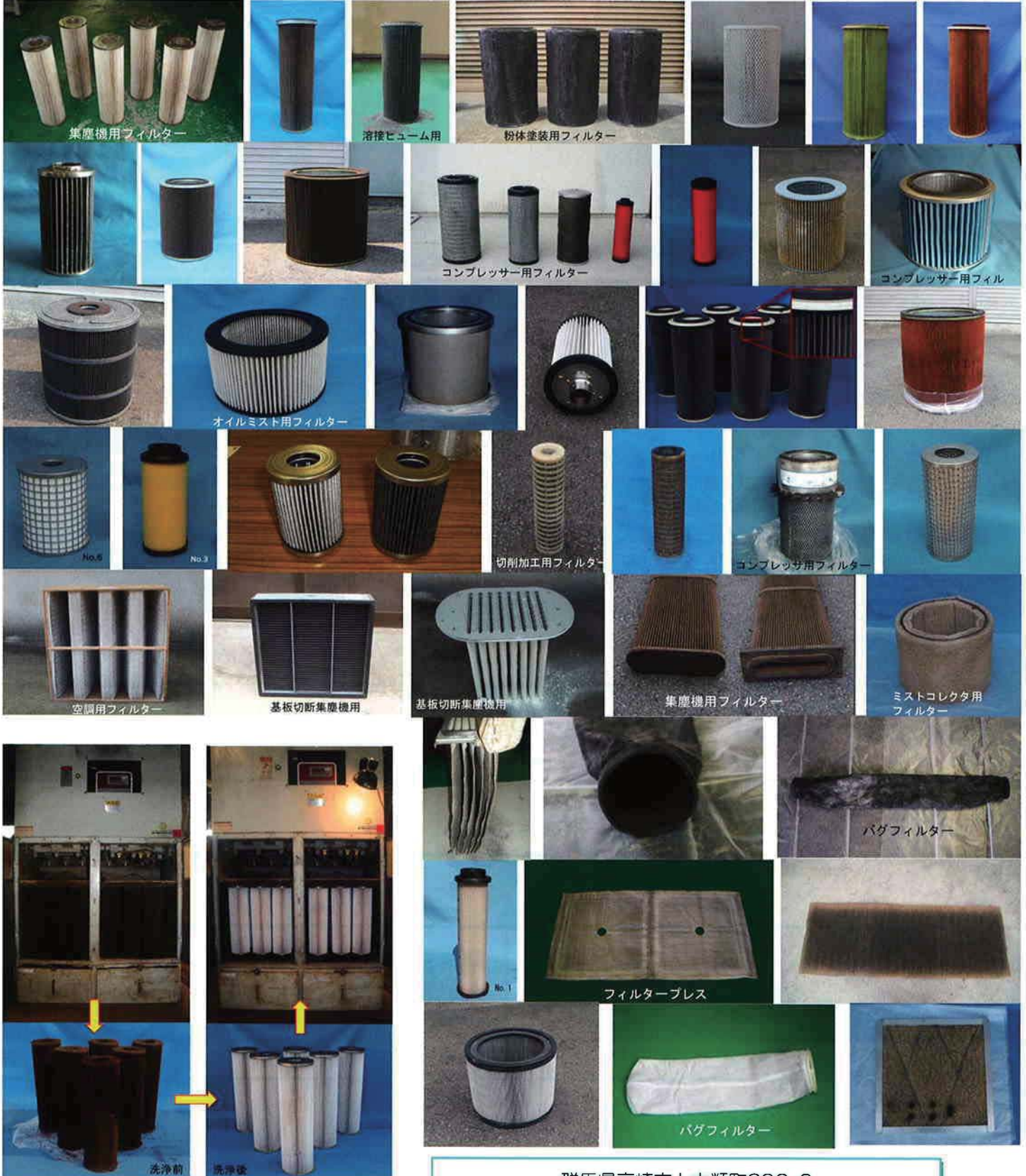
集塵機フィルター交換・洗浄
